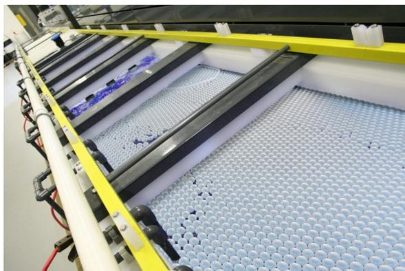
Euro-Matic-Kugeln finden in der Industrie Verwendung: in der **Elektroplattierung**; im **Phosphatierungsprozess**; in **Beizbädern**; beim **Galvanisieren**; **Brandgefahr** usw..
