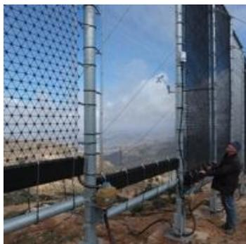
Der CloudFisher gewinnt ohne Energie Trinkwasser aus Nebel. Er ist weltweit der erste serienmäßige Nebelfänger, der Windgeschwindigkeiten von bis zu 120km/h standhält. Der innovative Kollektor lässt sich schnell und unkompliziert montieren, benötigt keine Energie und ist extrem wartungsarm. Alle verwendeten Materialien sind lebensmittelecht.
