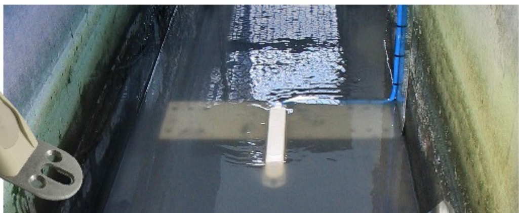
Luft-Ultraschallsensor zur Füllstandsmessung, Montage im Gerinnescheitel
